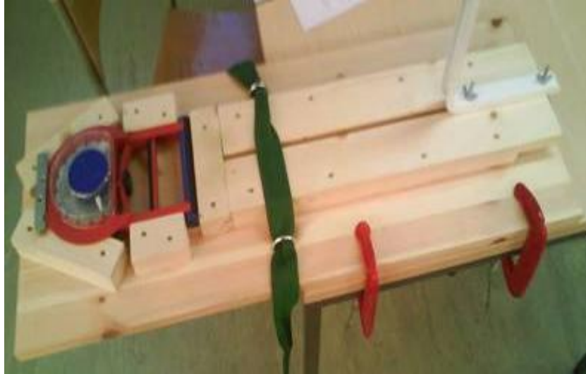
Abbildung 22. Modifizierter Hand-Dynamometer aus der Studie von Macdonald und Callender [108].
